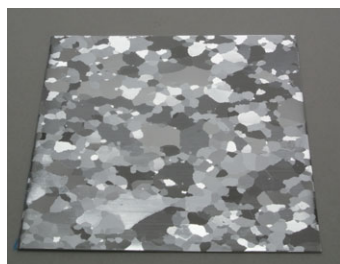
写真2. アルミ結晶パネル② 結晶のサイズが1~2cm程度のもの
