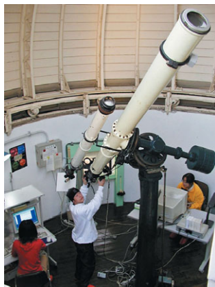
図3:別館ドーム内にある18cm屈折望遠鏡。現在でもリオフィルターを用いて、H \alpha 線での太陽の観測に使われています。
