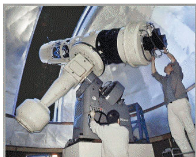
図6：60cm反射望遠鏡。1960年にツガミ製作所で作られた。主鏡は木辺成磨氏が磨いたもの。
