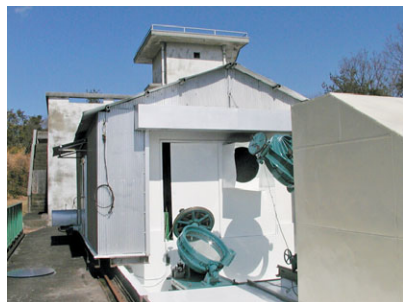
図4:太陽館に設置されている70cmシーロスタット望遠鏡。望遠鏡小屋の先にある1室全てを使った分光器では、太陽のスペクトルを目で見ることができません。
