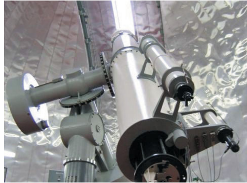
図7: 65cm屈折望遠鏡を見上げたところ。望遠鏡の筒の長さだけで12mを越える巨大なものです。
