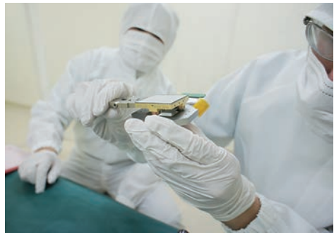
図4：赤外線検出器の組込み作業 (クリーンルーム)
