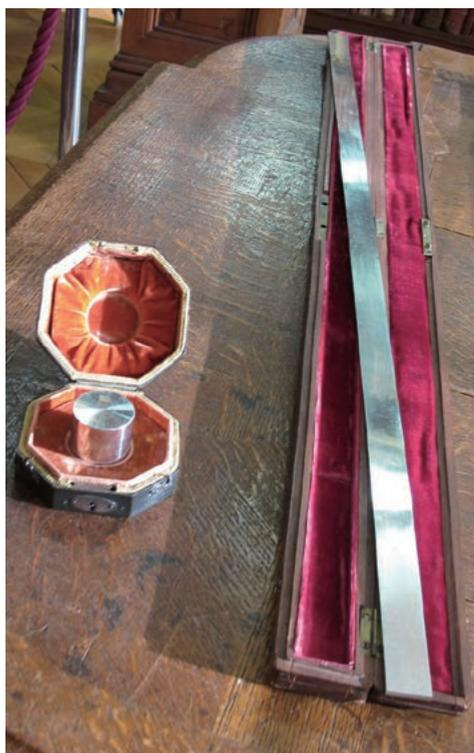
図1. 1799年にフランスのメートル法で採用された確定キログラム原器(左)と確定メートル原器(右)
