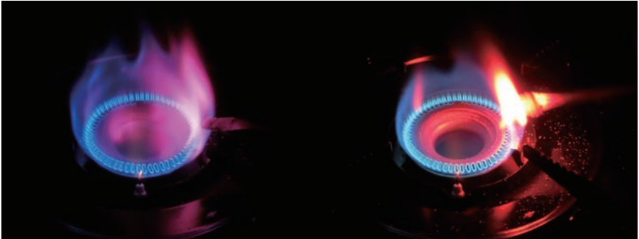
図. リチウム(左)とストロンチウム(右)の炎色反応。ガスコンロの燃料はブタン
