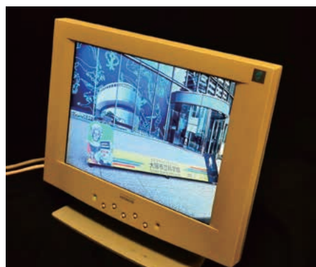
写真7. 13.3インチIPS-TFT液晶を搭載したモニタ第一号機
