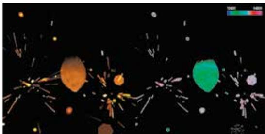
図8. カラー高速画像(左)と温度換算結果(右)
