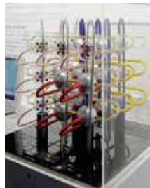
写真2. 6次元メッシュトラス構造のインターコネクトモデル
