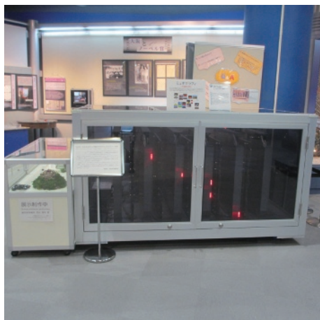
写真1. 展示場4階のミュオグラフィ装置。ミュオンを使って、火山のような巨大な物体の内部をレントゲン写真のように撮影できる。これはウラシマ効果の賜物。
