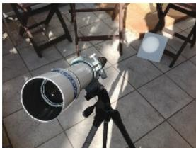
図：望遠鏡での投影
