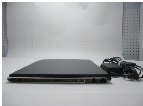
写真2. 横から見たすがた 最薄部16.6mm、重さ1.3kg、 当時としては超薄型・軽量ボディ
