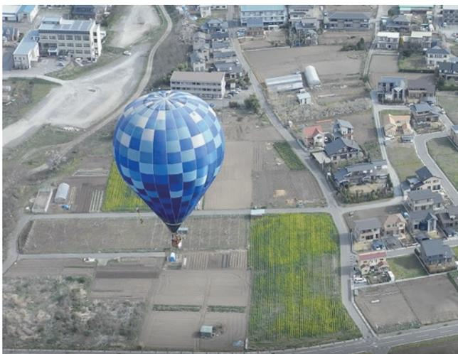
気を暖めて浮力を付け熱気球を上昇させます。暫くバーナーを焚かずにいると風船内部の空気は徐々に冷え、浮力が無くなり熱気球は降下を始めます。もっと早く下がりたときは、リップラインという紐を引くことによって熱気球の天頂部にあるパラシュートと呼ばれる調整弁を開け、風船内部の熱い空気を排出します。すると風船の下の方からは周囲の暖められていない空気が入り風船内部の温度が下がり、浮力が減ることによって、素早く降下することが出来ます。
