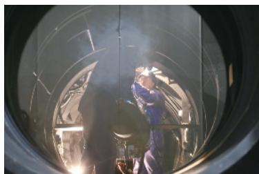
図5. カメラ取付作業の様子を筒先から補正板越しに見た図
