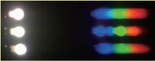
電球・蛍光灯・LEDの光のスペクトル
