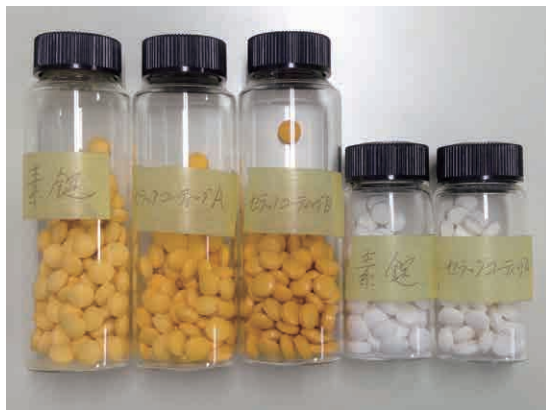
写真1. 錠剤サンプル:左から、黄色の「素錠」「セラックコーティングA」「セラックコーティングB」白の「素錠」「セラックコーティングA」
