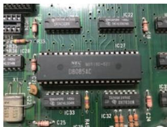
写真2. NEC TK-85のCPU
