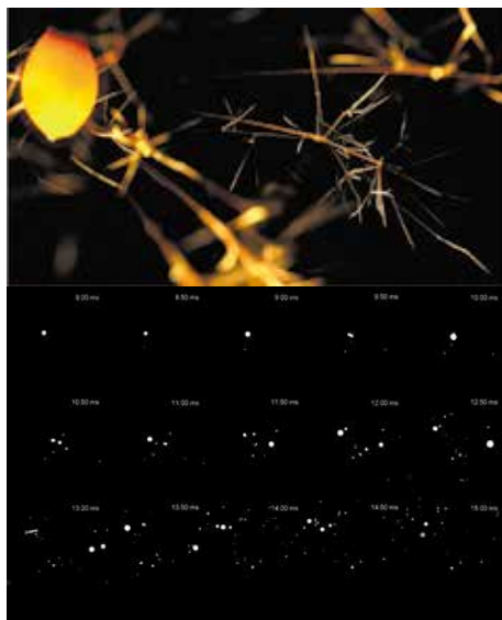
図7. 火花が枝分かれする様子 (上: 火球を飛び出した火花が4回ほど分岐する。Phys. Rev. Lett., 2017 下: 左上から右下に0.5 ms毎の火花液滴。はじめ一粒だった液滴が何度も分裂する。これが上図の松葉火花に見える。)
