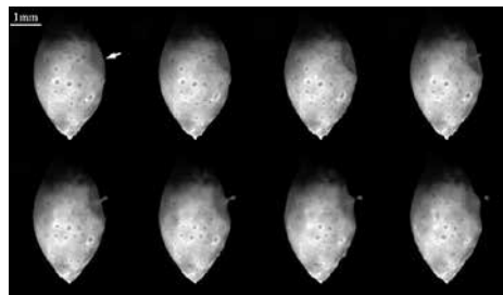
図6. 火球から液滴が飛び出す様子 (0.1msごとの白黒画像。矢印の気泡が 破裂して液滴が飛び出す。)
