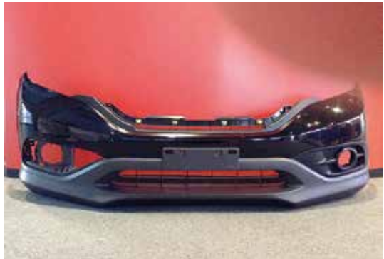
写真. 自動車のバンパー 幅1820mm、高さ620mm、奥行き420mm
