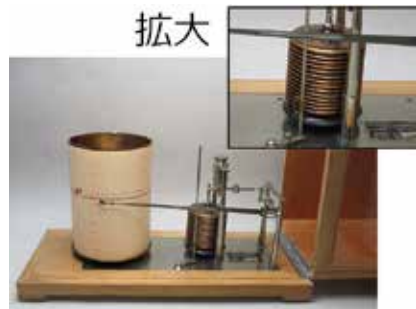
気圧計の内部
