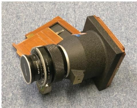
図. アストロカメラと乾板フォルダ(背後)
