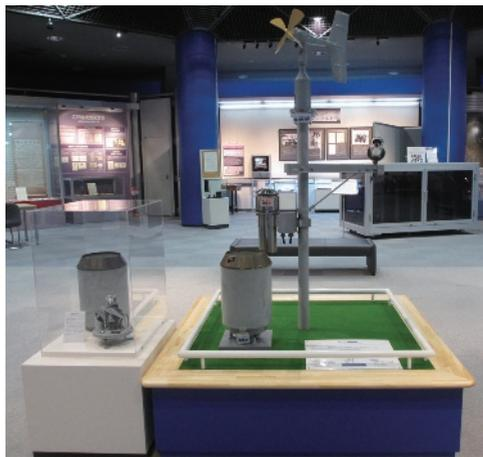
展示場4階「ミニ露場」と「転倒ます型雨量計内部」
