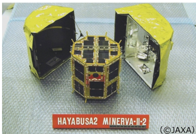
ミネルバII2の外観。 直径約15cm×高さ約14.5cm、質量877g
