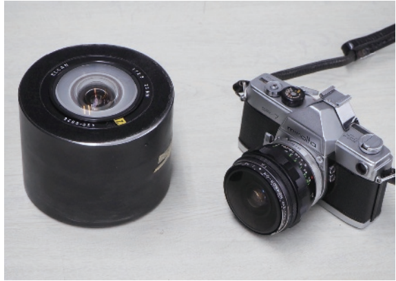
写真2. オムニマックスに使用されていた魚眼レンズ（右は魚眼レンズをつけた35mm版フィルムカメラ）
