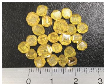
5万気圧以上・1300℃以上の超高压高温条件のもとで、鉄やニッケルなどの溶媒から温度差法により生成した合成ダイヤモンドです。硬さを必要とする工具、切削工具・ダイス・ドレッサーなどの材料に使用されています。大気中の窒素を不純物として含むので黄色ですが、最近では高純度で白色透明なものも合成可能となっています。
