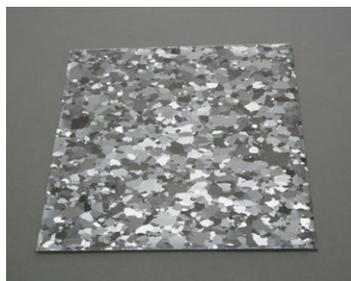
金属のアルミニウムの結晶が見えるパネルです。一つ一つの不規則な模様が、アルミニウムの単結晶で、特殊な方法で成長させ、このような複雑な模様を作り出しています。通常のアルミニウムでは、結晶の大きさは、せいぜい0.01~0.03mmと、とても小さく、このように結晶成長が見られるものではありません。金属の結晶形状、成長方法を知ることができる貴重な資料です。
