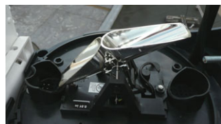
転倒ますの原理 内部の「ます」が左右に傾く
