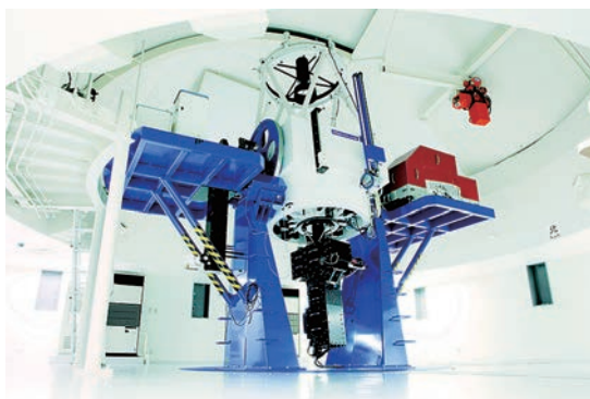
図2: 口径1.3m 荒木望遠鏡
