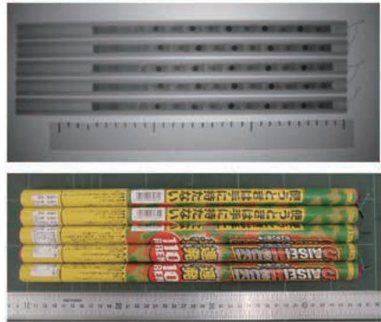
図6. 乱玉のレントゲン(上)と写真(下)
