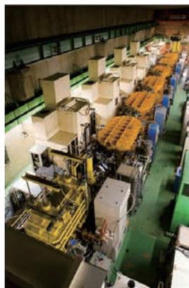
亜鉛の原子核を加速する加速器RILAC（写真提供：理研）
