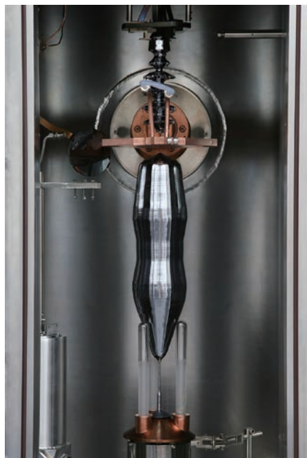
図6. ^{28}\text{Si} を99.99%まで濃縮して引き上げられた5kgの単結晶
