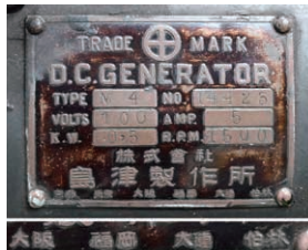
発電機の銘板
