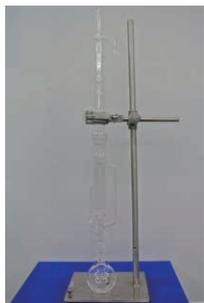
ソックスレー抽出機は固体に含まれる可溶性成分を連続抽出する実験装置です。一番下のフラスコに溶媒を入れ加熱すると、一番上の冷却管まで溶媒のガスが上がり、そこで冷却されて中間層にある固体に落ちて成分が抽出されます。写真では分かりにくいですが、中間層のガラス管の工夫でサイホンの原理が働き、この作用を繰り返すことで、可溶性成分を抽出する実験道具です。「化学と宮沢賢治」展で寄贈していただきました。
