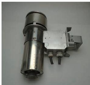
気象庁などで、気温を測るときに使われています。白金（プラチナ）を使っていて、「温度によって電気の流れやすさが変わる」という白金の性質を利用しています。
