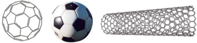
図5. フラーレン「C 60 」とサッカーボール(左)、カーボンナノチューブ(右)
