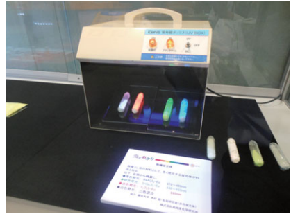
図3. 箱の中に紫外線を受け、RGBに光っている蛍光物質(右橋から3本)と、その3種混合物により白く光っている蛍光剤(左端)。
