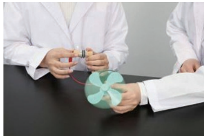
図5. 乾電池サイズのダニエル電池
