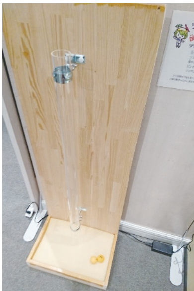
図1. 空気のあるを考えるパイプの中のボール落とし。ピンポン玉を上から落として、パイプの上の口をふさぐと…。
