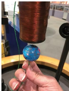
ところで、このミニ地球儀、フィードバック機構があっても、空中に浮かばせるのはなかなか難しく、すぐ落ちたり、電磁石にくっついてしまいますね。これは、ミニ地球儀を運ぶときに、指の影の分が光を余計にさえぎり、フィードバックがうまく働かないからです。
