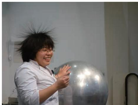
バンデグラーフ起電器。大きな静電気を発生させることができます。
