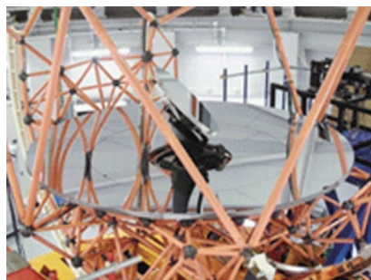
図5. せいめい望遠鏡。口径3.8mの主鏡は花びら構造をなす18枚の鏡からなっている。
