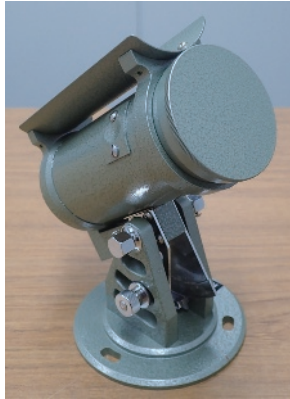
ジョルダン式日照計 左：外観 上：内部の様子
