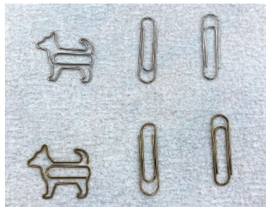
写真4. クリップ 上:実験前 下:金メッキ後
