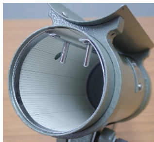
ジョルダン式日照計 左: 外観 上: 内部の様子
