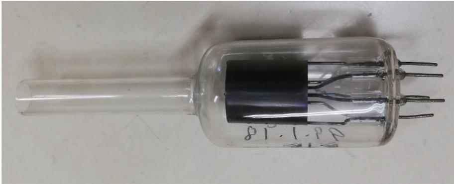
**写真** 電離真空計。真ん中の黒い筒がコレクタ。右側に電極が伸びている。真空管は通常真空に封じられているが、この真空計は、左側のガラス管が開いていることに注意。
