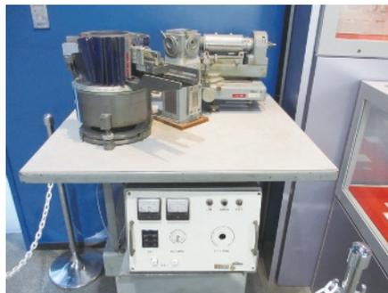
図1. X線回折装置
