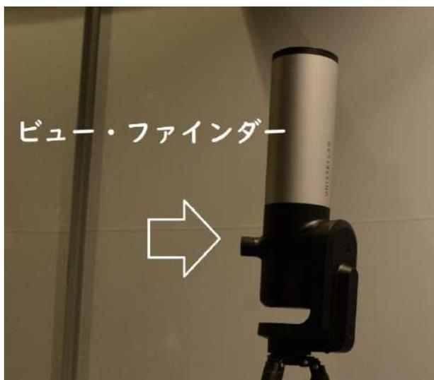
図3. ビュー・ファインダー。実際に望遠鏡をのぞくイメージで見られる。内部に小型の有機 EL モニターが入っており、それをのぞかち。光学的には望遠鏡と接続していない。
