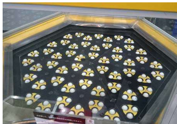
図4-1. 核分裂連鎖反応シミュレーションの装置
