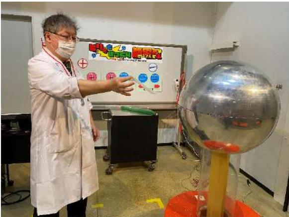
バンデにくっついたティッシュは、バンデから電荷を受け取り、バンデから飛び出す。バンデの放電球の高さで掌を立てて適当な間隔を取ると、ティッシュは放電球と掌の間を何度も往復する。
