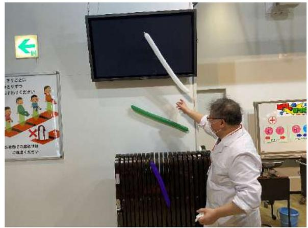
バルーンは誘電体なのでバルーンに帯電した電荷は移動しにくい。そのため分極して生じたプラスと中和しないのである。そのため、電流の流れやすい金属フェンスにもくっつく。
