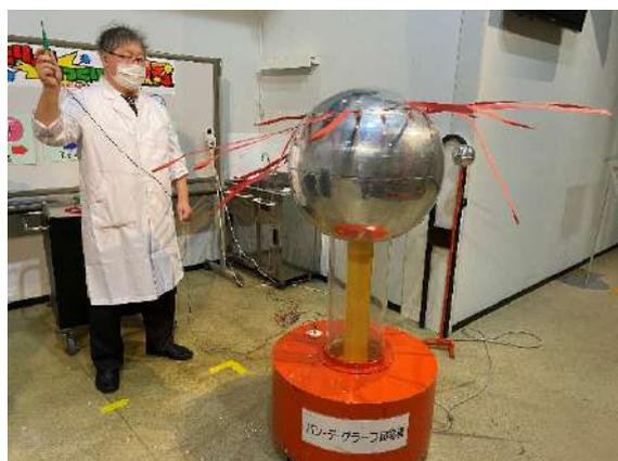
大地からくみ上げられた電荷は、帯電球に溜まり、紙テープに移り、さらに紙テープから空中へと逃げていく。しかし、カンタンには逃げられないので、逃げ場を探している状況である。演者が手を近づけると紙テープが手に依ってきて、電荷を渡して垂れ下がる。電荷は、演者の体を通じて大地へと逃げていく。
