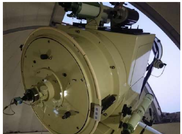
図8 星の子の90cm反射望遠鏡（カセグレン焦点14320mm）と同架15cm望遠鏡（焦点距離：1800mm） 写真：星の子館提供
