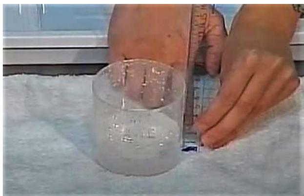
写真9. 雨の量をはかる(定規で水の深さを測る)
