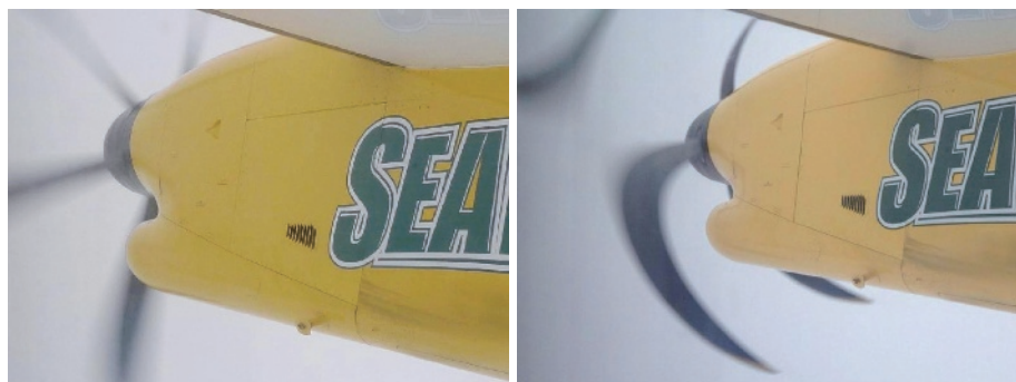
図3. CCD(左)とCMOS(右)を使用したカメラで撮影した飛行機のプロペラ
