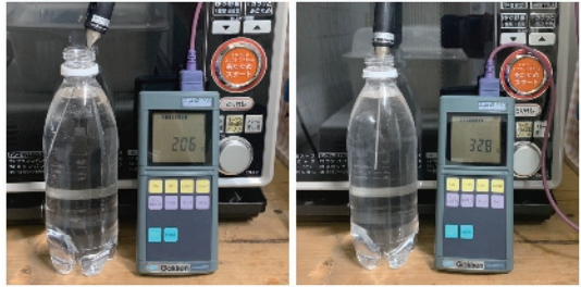
図2. 水500gを出力500Wの電子レンジで1分加熱した場合の温度変化
