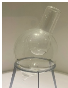
図5. デュワーが考案した実験用フラスコのレプリカ(まほうびん記念館蔵)
