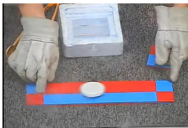
写真 10. ピン止め効果でレールの上を滑る超伝導体
