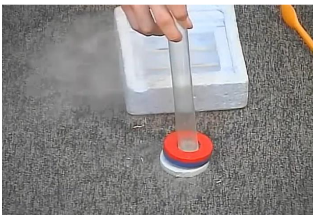
写真 8. 超伝導体の上で徐々に反発を弱める磁石
