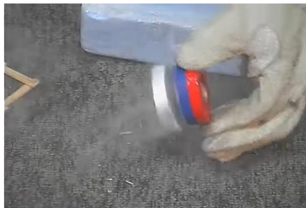
写真 9. ピン止め効果で宙に浮かぶ超伝導体
