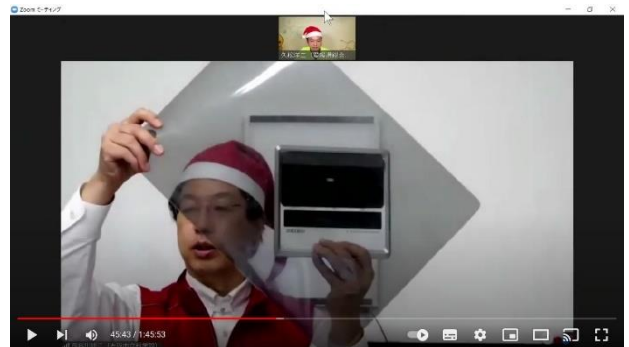
写真11. 偏光板を通すと見えない液晶表示の時計
