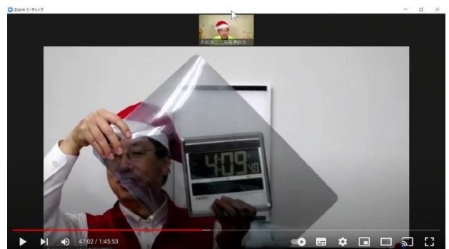
写真12. 偏光板を剥がした液晶時計
