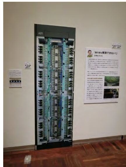
写真38. 「富岳」コンピュータ筐体実物大パネル。これが 432 台で富岳全体を成すことは左のキャプションで紹介した。
